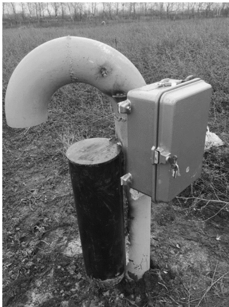
Рис. 7. Система автоматического мониторинга газовыделения и температуры рекультивированной свалки
